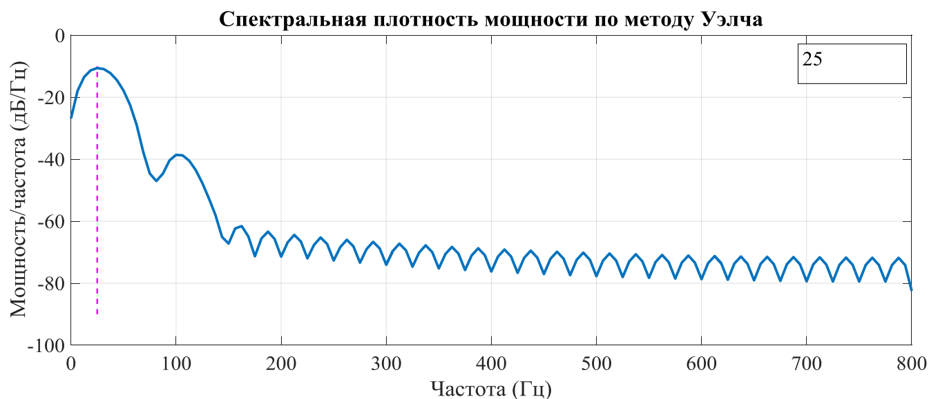
Рисунок 4.13 – Определение частоты напряжения свободных колебаний по методу Уэлча
