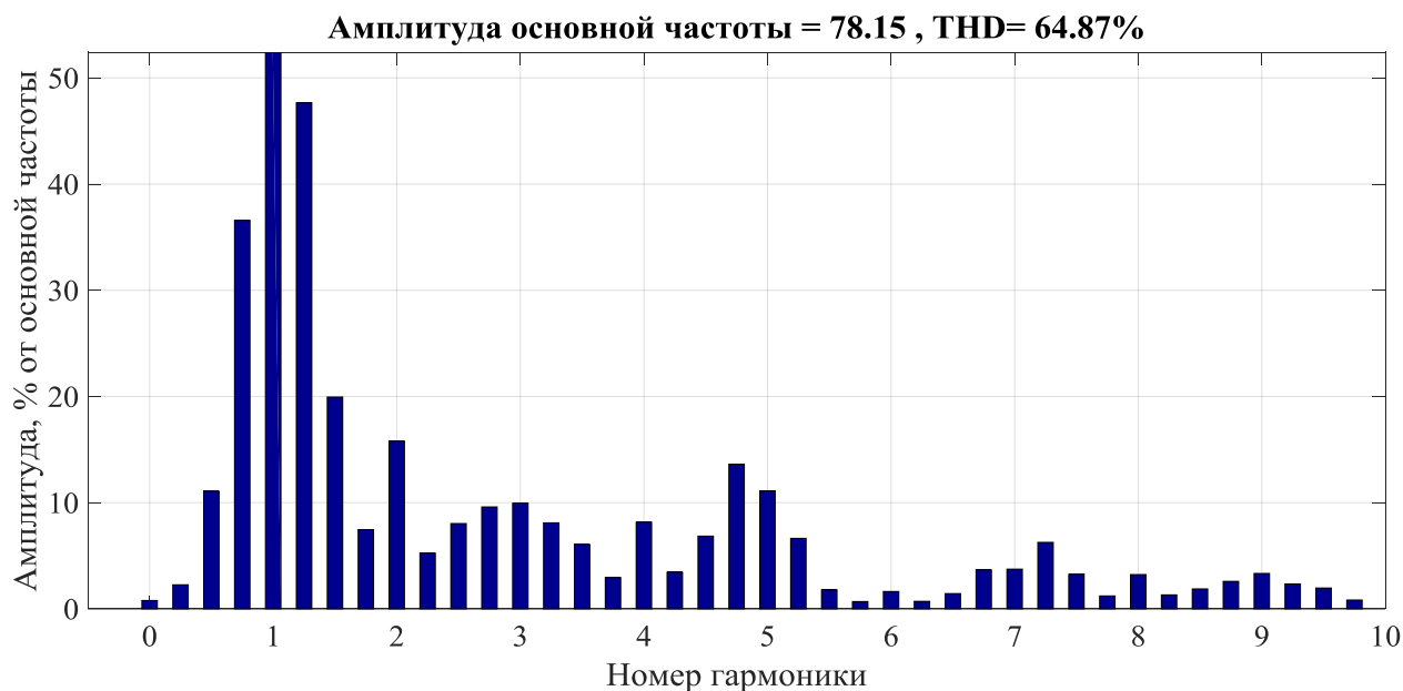
Рис. 2.50 – Быстрое преобразование Фурье спектра тока фазы С
