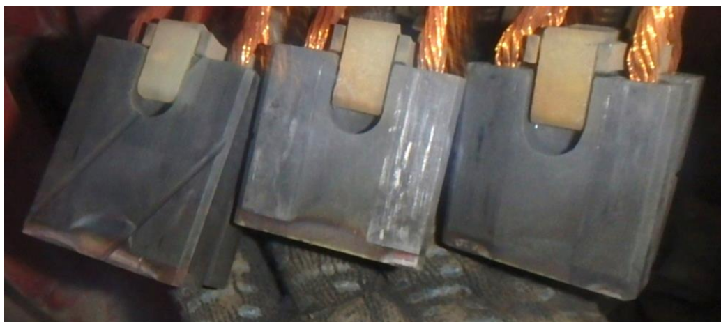
Рисунок 1.11 – Следы подгаров на сбегающем крае щеток
