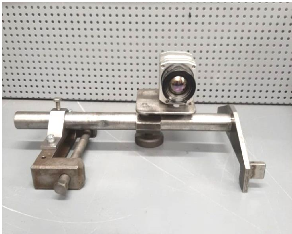
Рисунок 2.3 – Приспособление для закрепления видеокамеры к остову ТЭД
