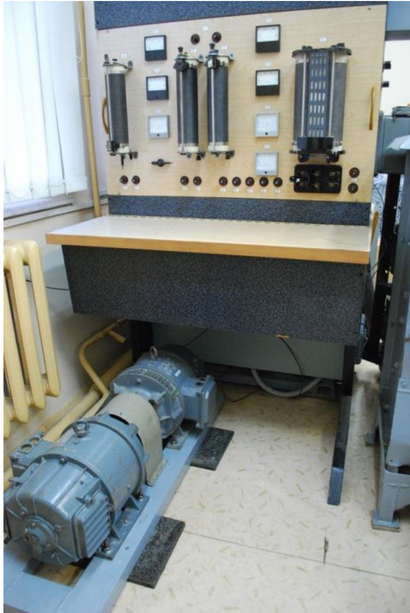
Рисунок 4.2 – Экспериментальная установка для исследования тепловых процессов в КЩУ МПТ
