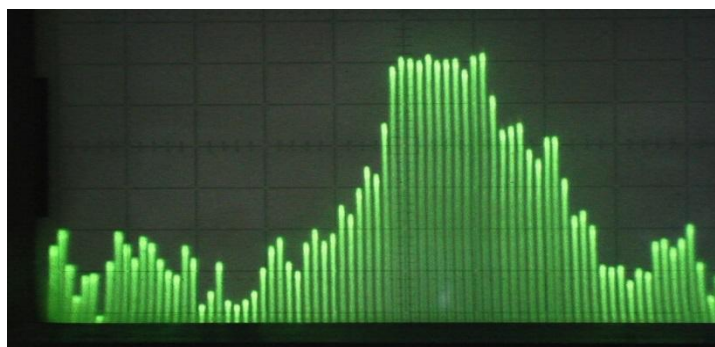
Рисунок 5.9 – Осциллограмма профиля коллектора
