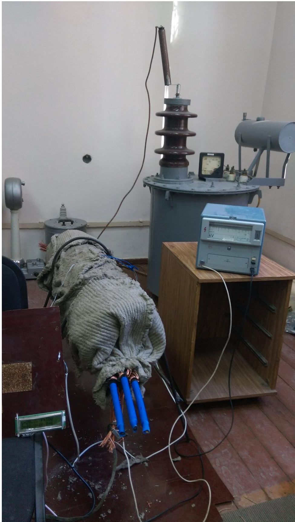
Рисунок Г.4 – Фотография процесса искусственного состаривания образцов кабеля.
