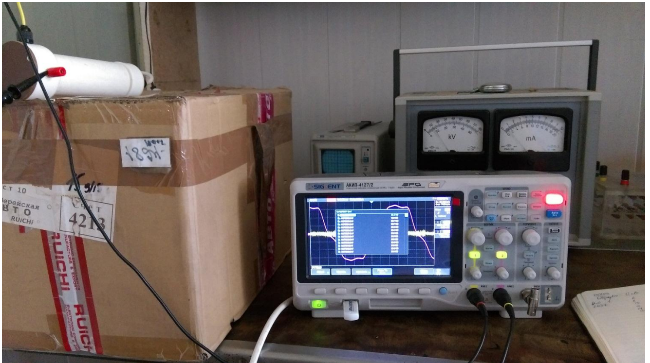
Рисунок Г.2 – Фотография процесса записи сигналов ЧР осциллографом.
