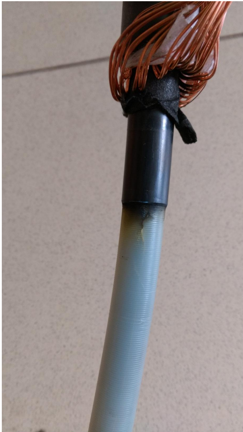
Рисунок Г.5 – Фотография пробоя кабеля в области концевой заделки.
