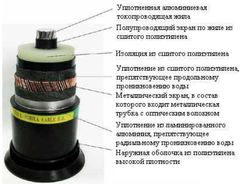
Рисунок 4.4 – Пример конструкции кабеля с изоляцией из сшитого полиэтилена с оптоволоконной жилой.
