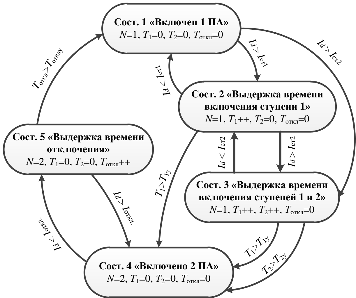
Рисунок 3.3 – Диаграмма состояний переходов конечного автомата алгоритма 2
