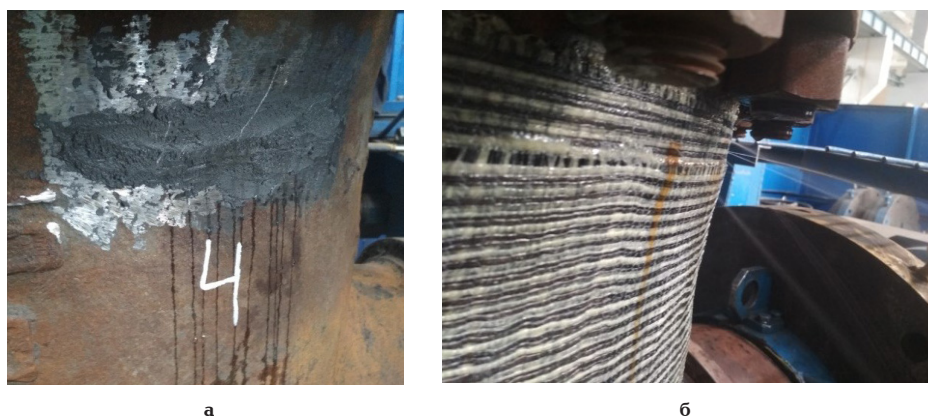
Рис. 8. Разгерметизация ремонтных участков на образцах 2 (а) и 3 (б)
