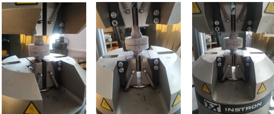
Рис. 4. Образцы, установленные в разрывную машину для испытаний, охлажденные до -60\text{ }^{\circ}\text{C}
