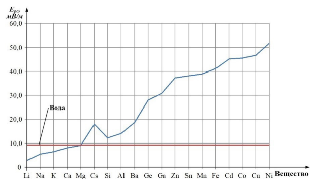
Рис. 6. Зависимость разрешающей способности E_{pc} для разных веществ (металлов и полупроводников) с плотностью до 10000 кг/м 3 и температурой плавления до 1600 °С
