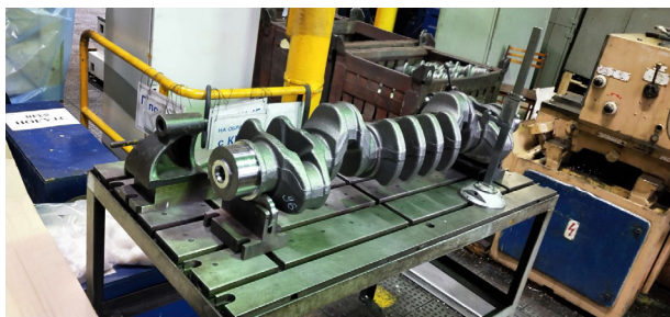
Рис. 4. Цеховое измерительное приспособление для контроля геометрических показателей поковок коленчатых валов на роликовых опорах
