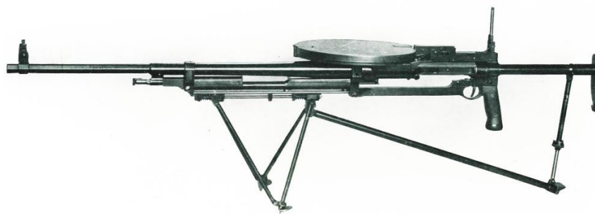
Рис. 3. Пулемет Beardmore-Farquhar Vickers. 5 с дисковым магазином на 29 патронов [28, с. 9]
