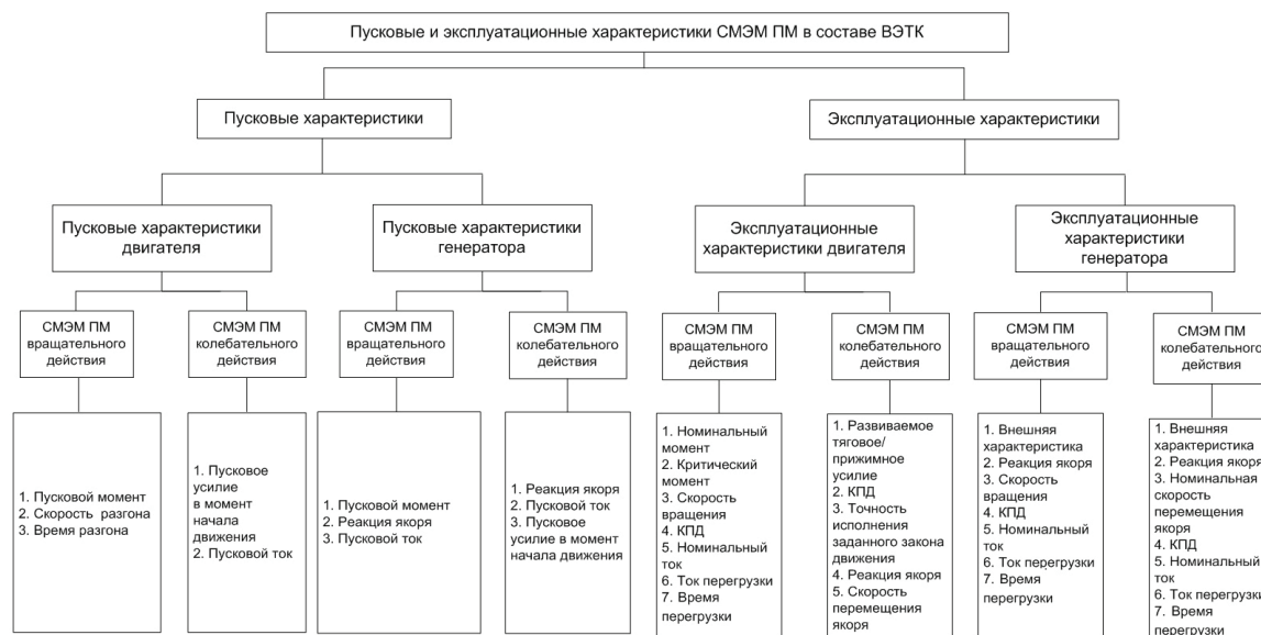
Рис. 4. Классификация пусковых и эксплуатационных характеристик ВЭТК на основе тихоходных магнитоэлектрических машин
