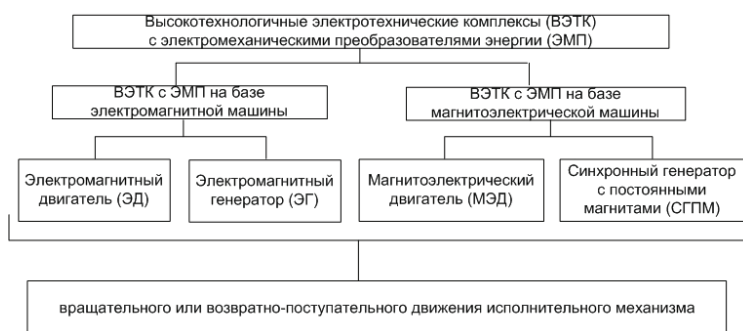
Рис. 2. Структурная схема ВЭТК с электромеханическим преобразователем
