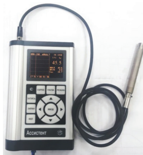
Рис. 2. Прибор для измерения шума «Ассистент»
