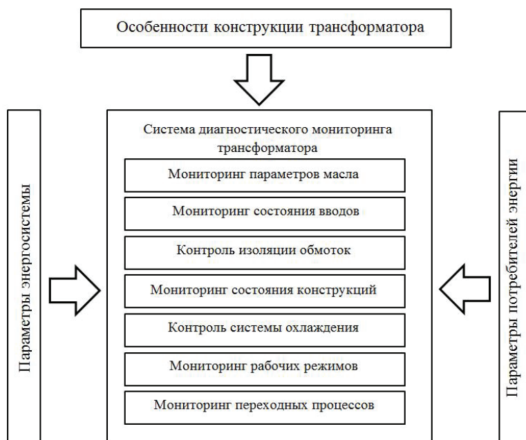
Рис. 1. Состав системы диагностирования силового трансформатора
