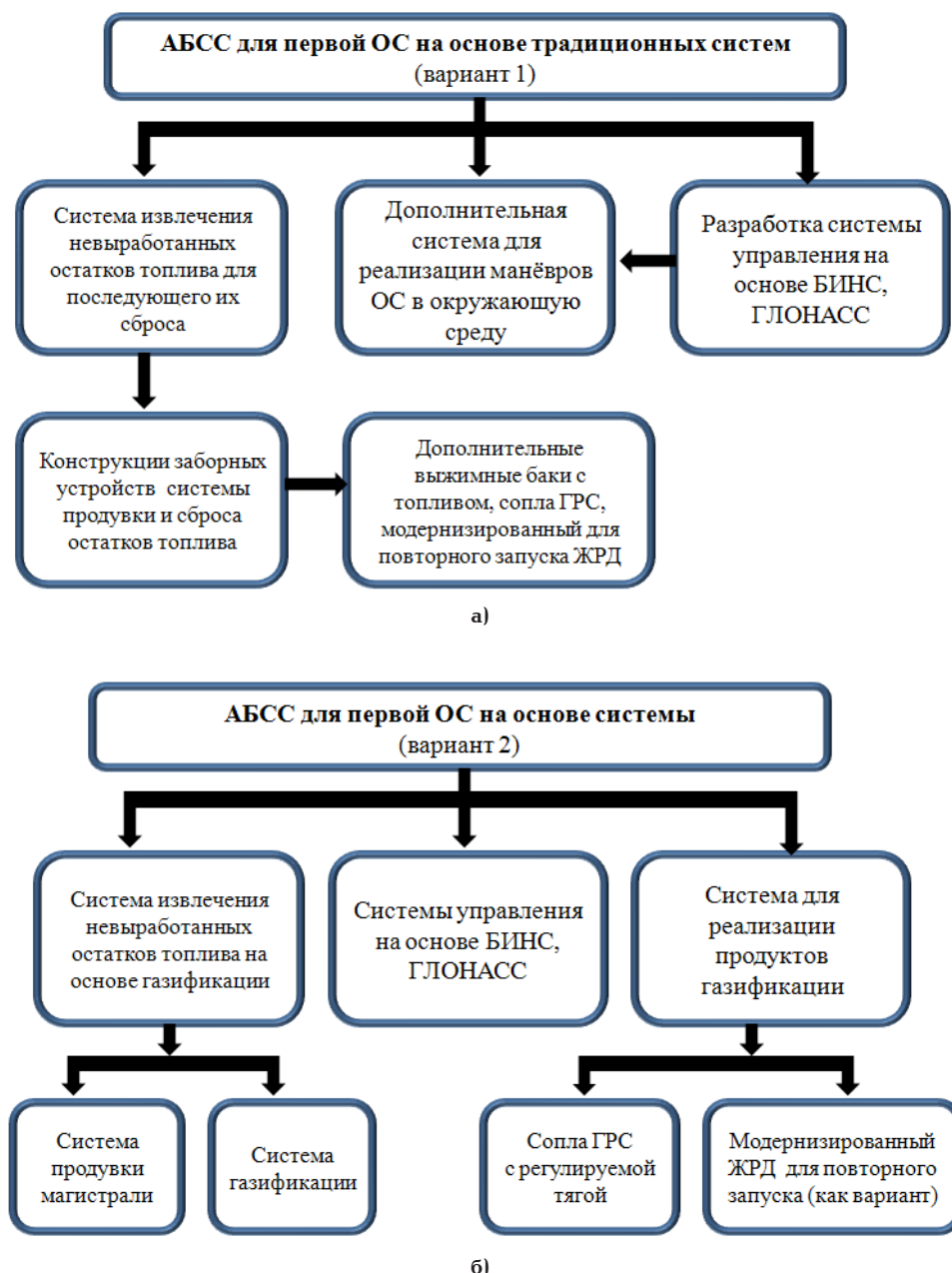
Рис. 1. Технологические и схемные варианты решения задачи ликвидации невыработываемых остатков КРТ в баках и топливных магистралях РН после выключения маршевого ЖРД; а) традиционный вариант на основе использования отработанных технических решений; б) предлагаемый вариант на основе испарения остатков КРТ Fig. 1. Technological and circuit options for solving the problem of eliminating unused RP residues in the tanks and fuel main lines of the LV after shutdown of the main LRE: а) the traditional version based on the use of proven technical solutions; б) the proposed option based on the evaporation of residual RP
