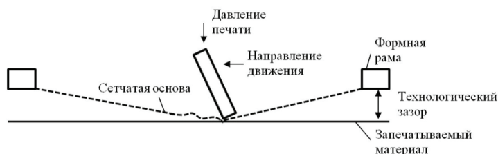
Рис. 1. Деформация печатной формы под действием ракеля
