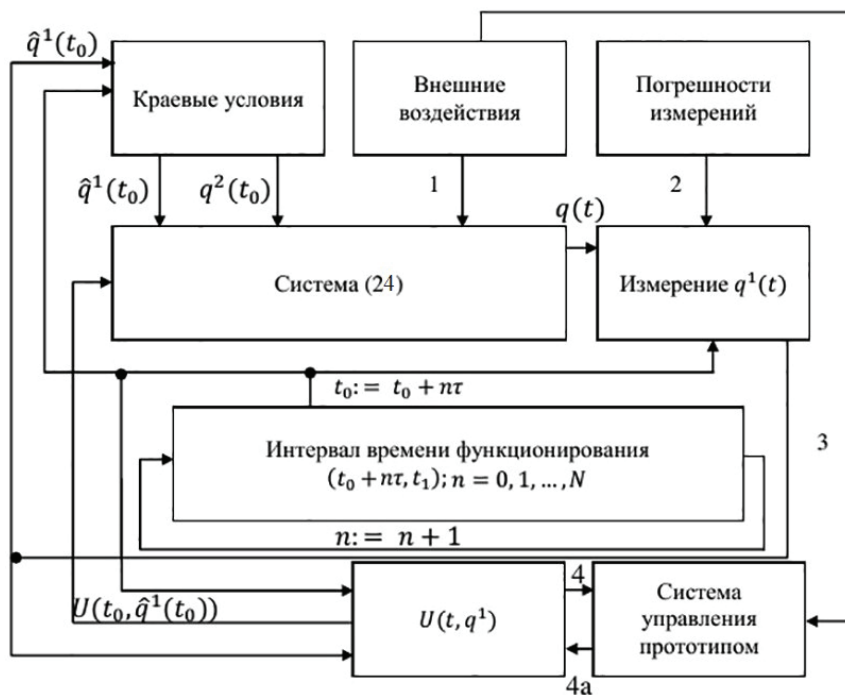
Рис. 1. Функциональная схема алгоритма управления в фиксированном режиме движения
