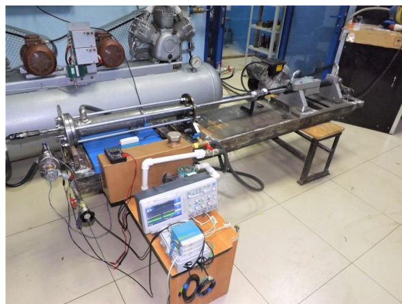
Рис. 1. Экспериментальный стенд с установленной тихоходной длинноходовой ступенью Fig. 1. Experimental stand with an installed slow-speed long-range stage
