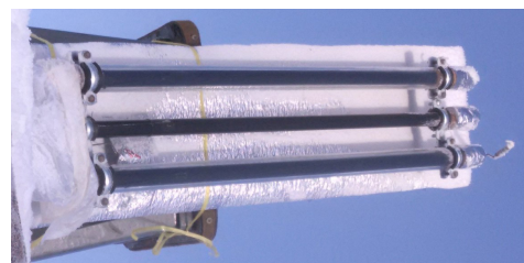
Рис. 3. Фотография измерительного модуля экспериментального стенда в положении под углом 71,5 градуса к горизонту Fig. 3. The photograph of the measuring module of the experimental stand position at an angle of 71,5 degrees to the horizon
