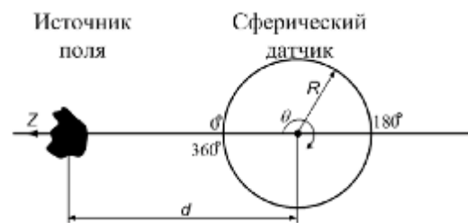
Рис. 2. Схематическое изображение сферического датчика относительно некоторого источника поля с указанием направления оси сферического датчика Z , где d — расстояние от источника ЭП до центра сферического датчика; R — радиус сферического датчика; \theta — широтный угол сферической системы координат
