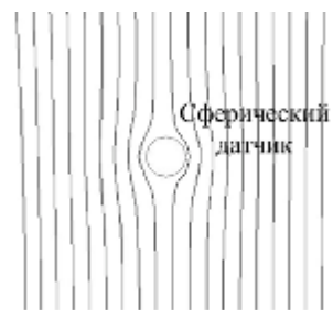
Рис. 4. Силовые линии потенциала однородного поля при внесении в него модели изолированного сферического датчика
