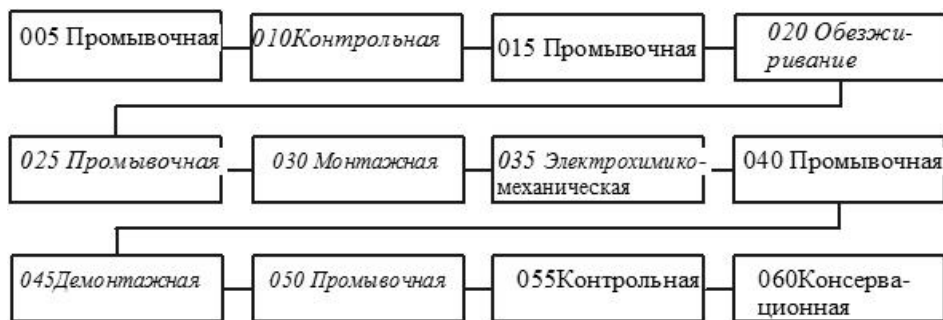
Рис. 2. Маршрутная схема технологического процесса восстановления плунжерных пар топливного насоса высокого давления
