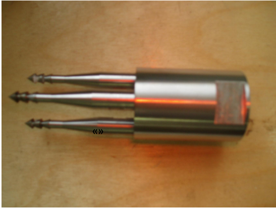
Рис. 2. Волновод - инструмент и рабочая часть типа «елочка»
