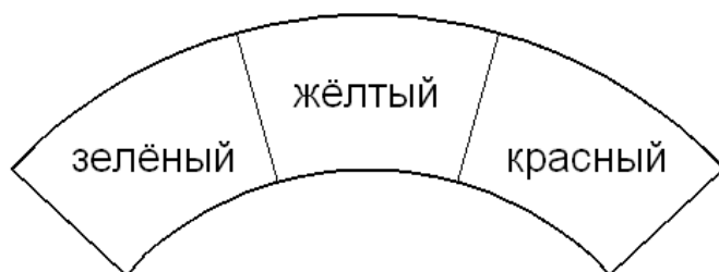
Рис. 1.15. Цветовое деление шкалы прибора
