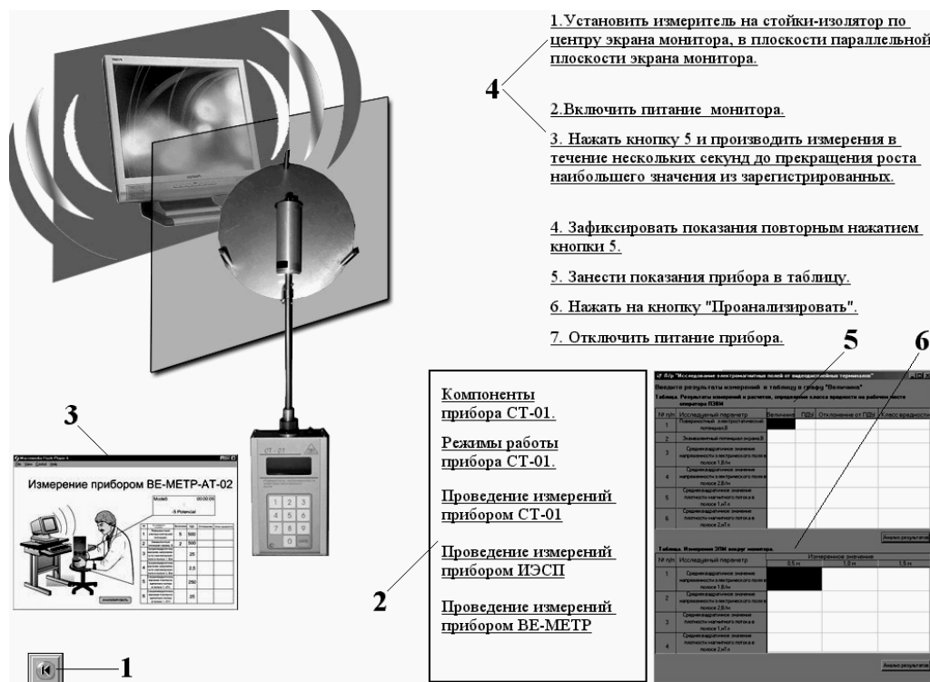
Рис. 29. Страница «Порядок проведения лабораторной работы»: 1 – кнопка «Назад»; 2 – табло с кнопками вывода на экран анимированных программ; 3 – одна из анимированных программ по измерению поверхностного электростатического потенциала; 4 – интерактивные кнопки действий обучаемого; 5 – отчетная таблица результатов измерений и расчетов; 6 – измерения ЭПМ вокруг монитора
