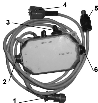
Рис. 1. Сигнальное звуковое устройство механика-водителя Т-72Б:
